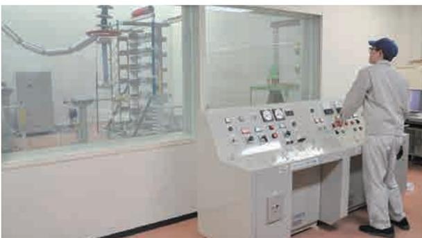
高電圧現象を学ぶ実験室です。実験を通して安全に電気を送る技術を学びます。
