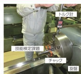
チャック締め付け力測定
