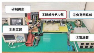
直流アーク放電実験装置
