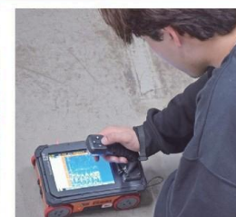
鉄筋コンクリートの内部を透視。まるで建築を診断する医師のよう。
