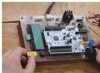
形状記憶合金ワイヤに電流を流すために必要な電子回路で、卒研の学生が作成したものです。
