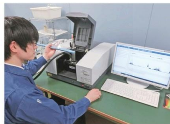
フーリエ変換赤外分光光度計を使ってガス濃度を測定している研究学域生。鏡で反射させた2.4mの距離を、対象となるガス中に赤外線を通過させます。吸収した波長から分子の構造や濃度を評価します。
